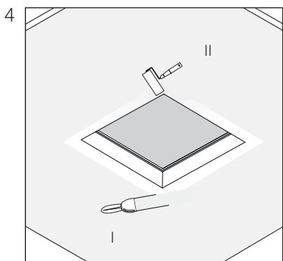
4 После установки следует зашпательвать швы, покрасить потолок и гипсовый корпус светильника.
