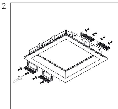
2 Отрегулируйте крепежный элемент (поз. 4) в зависимости от толщин потолка. Закрепите его с помощью винтов (поз. 5) и шайб (поз. 7), идущих в комплекте.
