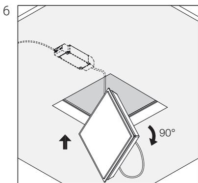
6 Устанавливать световой модуль в корпус следует, предварительно повернув его под 90° от рабочего положения.
