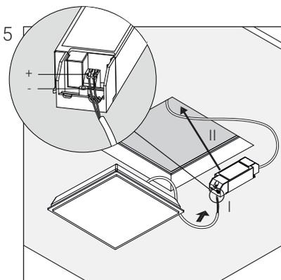
5 Подключите световой модуль (поз. 2) к блоку питания (поз. 3). Блок питания к электросети (см. схему подключения), а затем установите его за гипсокартонный потолок.
