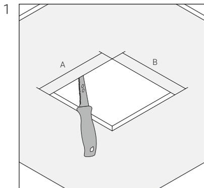
1 Сделайте отверстие в гипсокартонном потолке, соответствующее выбранной модели (размер АхВ) (см.паспорт светильника).
